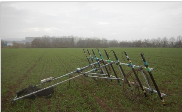
Foto: Mehrkanaliges Fluxgate-Magnetometer mit Sonden der Fa. Sensus auf der zu untersuchenden Fläche
