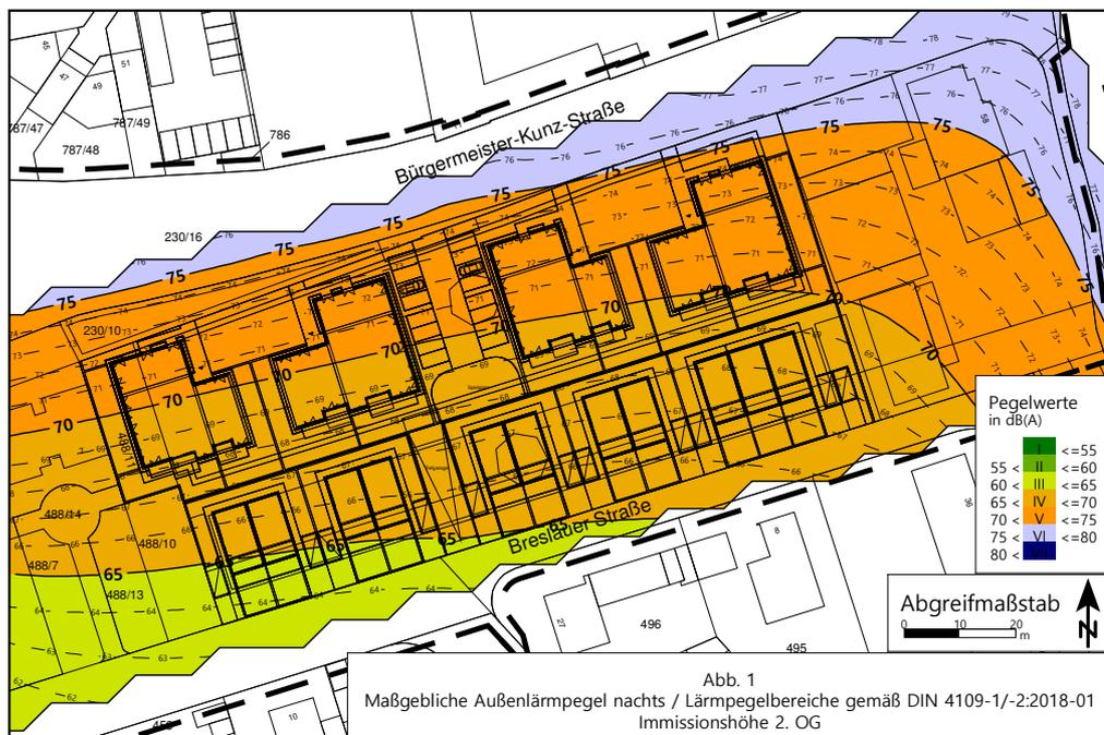
Die erforderlichen Schalldämm-Maße der Außenbauteile sind im Baugenehmigungsverfahren gemäß DIN 4109-1:2018-01 und DIN 4109-2:2018-01 nachzuweisen.
